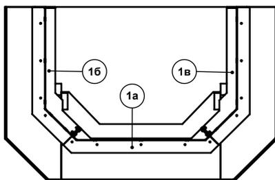
Детали №1а, 16 и 1в необходимо перед установкой соединить вместе в соответствии со схемой сборки
